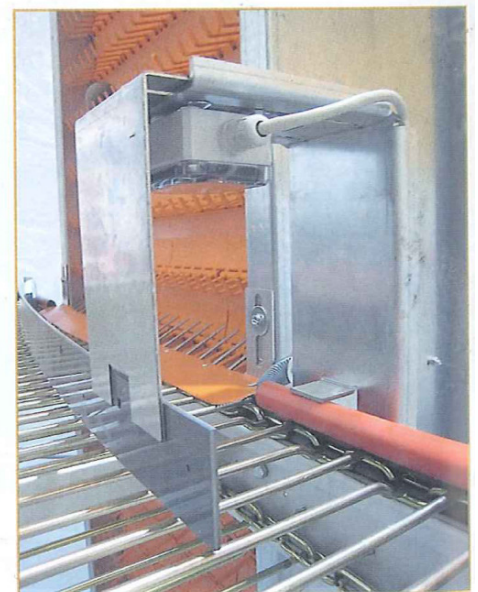
Рисунок 2. Установка счетчика на транспортере яйцесбора.
